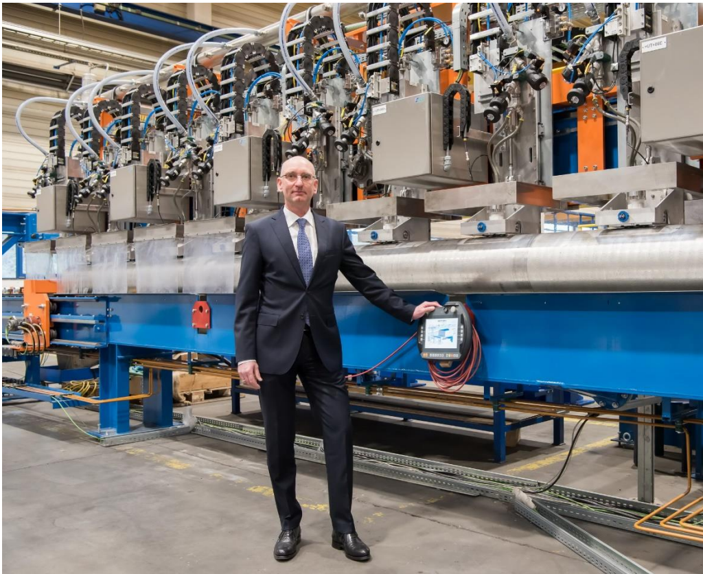
Gerold Keune im Hertwich-Werk vor einer der leistungsfähigsten Ultraschallprüfanlagen mit bis zu AA-Prüfqualität und intuitiven Bedienfunktionen.
